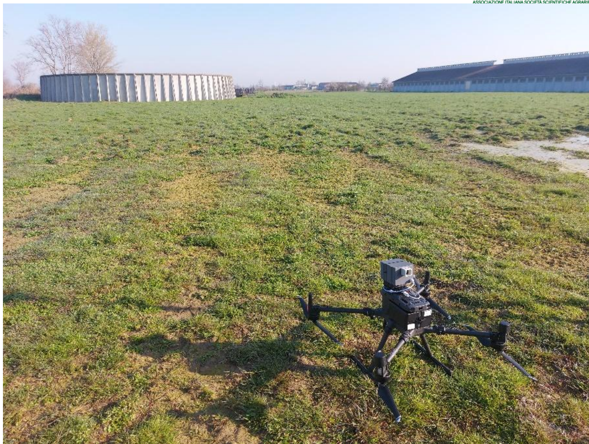
Figura 3 - Monitoraggio delle emissioni gassosi e di particolato in un allevamento di suini. Una centralina multisensore è collocata su un aeromobile a pilotaggio remoto (APR), impiegato per misurare le concentrazioni di inquinanti nei dintorni della porcilaia e delle vasche di stoccaggio dei reflui.
