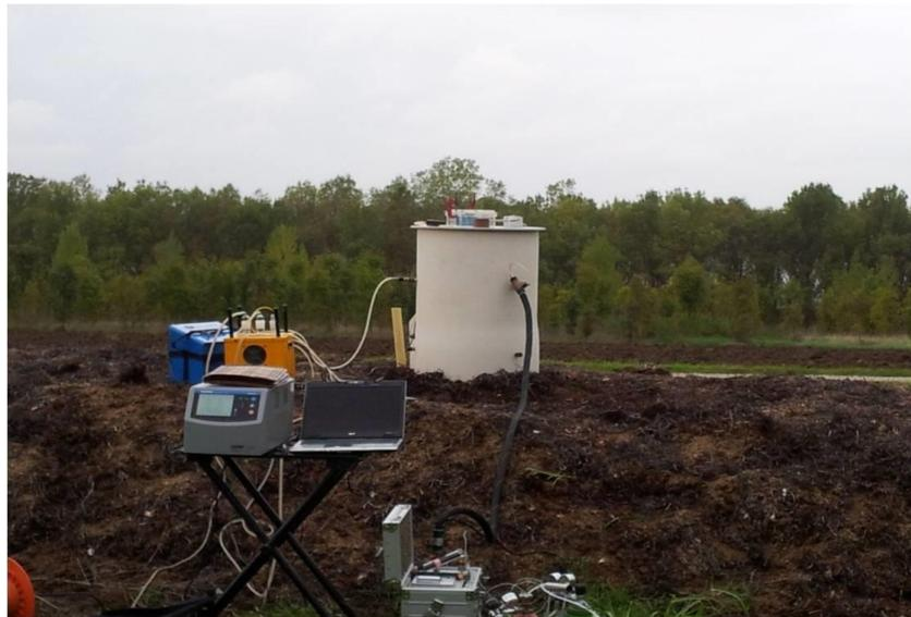
**Figura 7.** Sistema di campionamento delle emissioni di gas inquinanti durante il processo di compostaggio in prove condotte dal DSA3 in collaborazione con ARPA.
