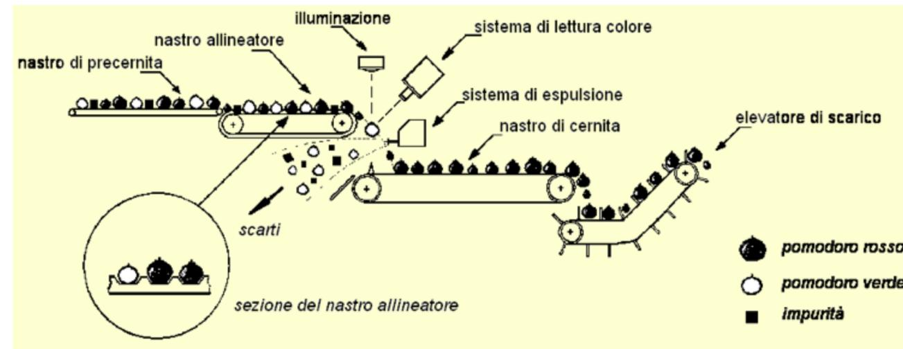
Le ultime macchine per la raccolta sono dotate di uno o più dispositivi di selezione ottica.
